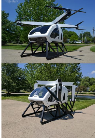
그림 3_ 슈퍼플라이는 드론 형태를 취한 하이브리드 헬리콥터다. 미래에는 자율비행을 상정하고 있다.
